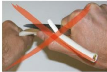
Figura 1.19. Uso incorrecto. Técnica peligrosa.
